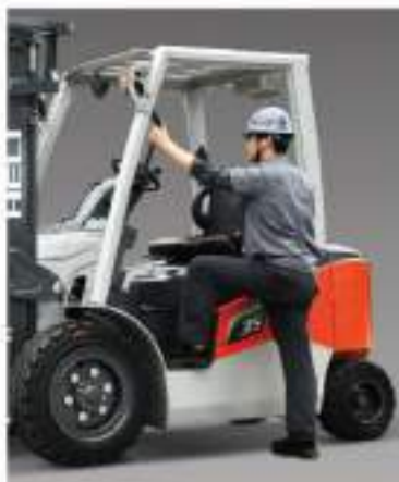
Obszerne dojście do stanowiska operatora i dużo miejsca na nogi ułatwiają wygodną pracę.
